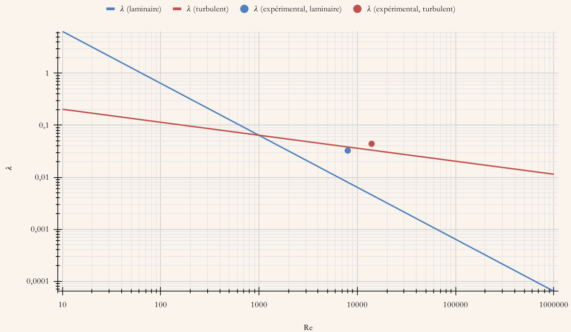
Figure 4. Coefficient de perte de charge en fonction du nombre de Reynolds
